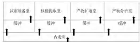
图5 普通型 PCR 实验室气流流向
