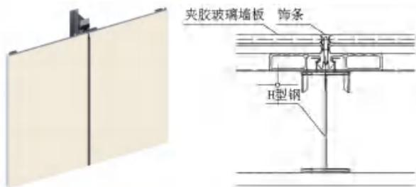
图 4 玻璃隔断连接局部图
