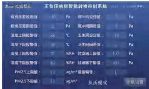
图 4 正负压病房智能转换控制系统设置
