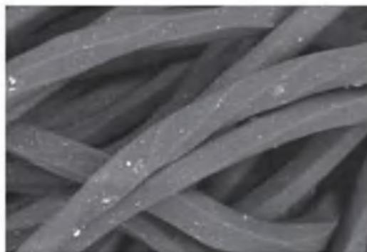
图 6 FiberShield 银离子聚合尼龙纤维表面
