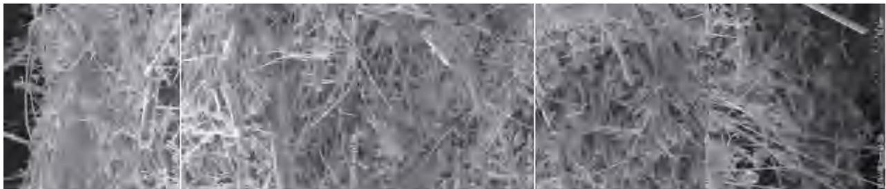
图5 H14滤料样品截面电镜结果(上游 $10\text{mg/m}^3$ )
