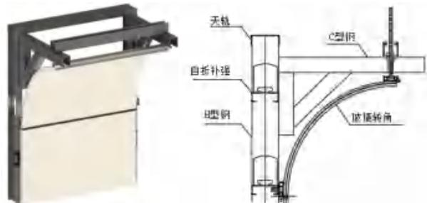
图 5 玻璃隔断圆弧转角局部图
