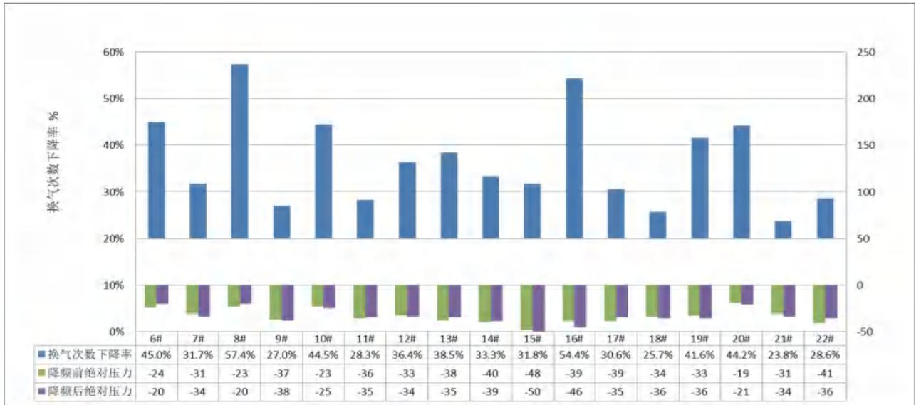
图4 降频前后换气次数下降率与压力变化对比(定进变出)
