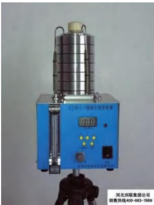
图 3.3 撞击式空气微生物采样器
