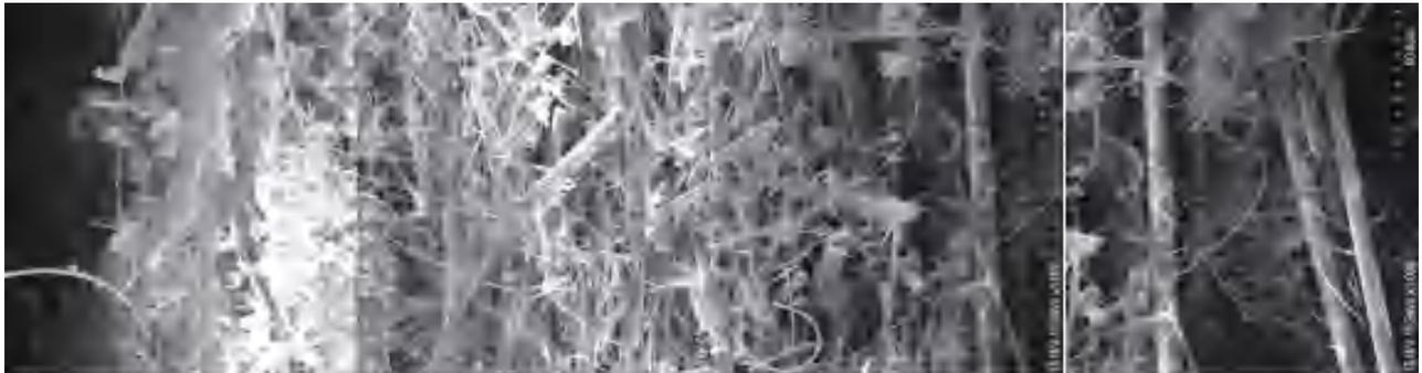
图7 H14 高效过滤器滤材样品截面电镜结果 (NaCl 尘源)
