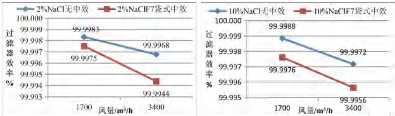
图 1 不同尘源时 H14 过滤器不同风量不同钠焰法效率对比 (左图 2%NaCl; 右图 10%NaCl)
