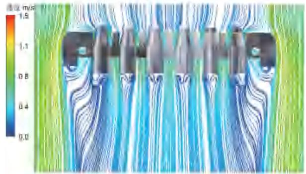
图5 灌装操作区域送风效果流线图
