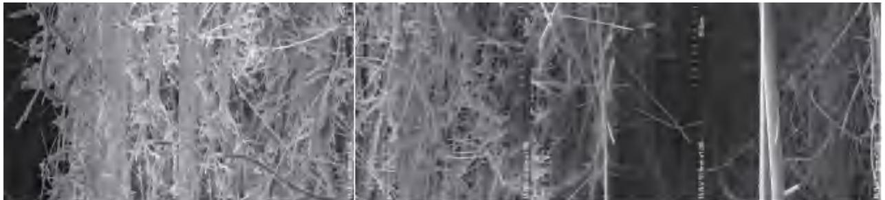
图8 H14 高效过滤器滤材样品截面电镜结果 (KCl 尘源)
