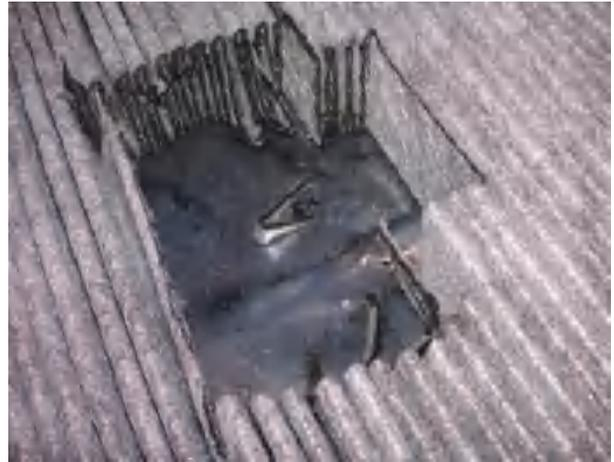
图 10 已使用过滤器的滤料裁剪
