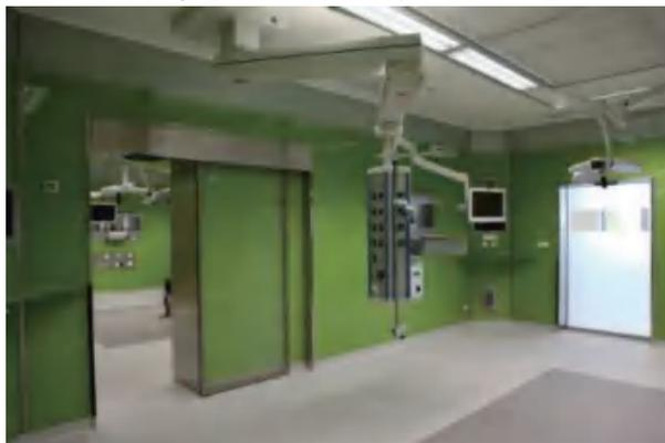
图 6 带防辐射移动隔断的通仓手术室
